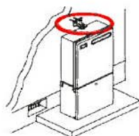
据置型給湯器の上部を壁に固定する部位
