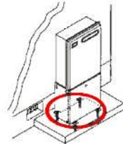
ガス給湯器の底部のみを基礎に固定する部位
